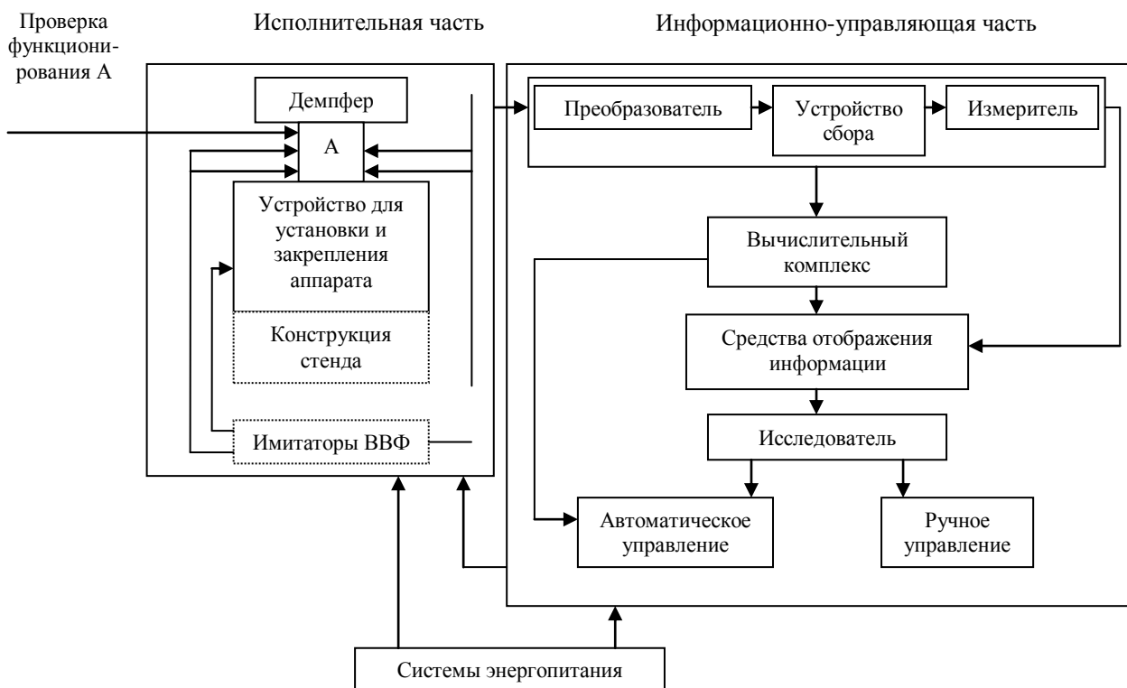
Рис. 1.24. Структурная схема автоматизированного испытательного стенда
