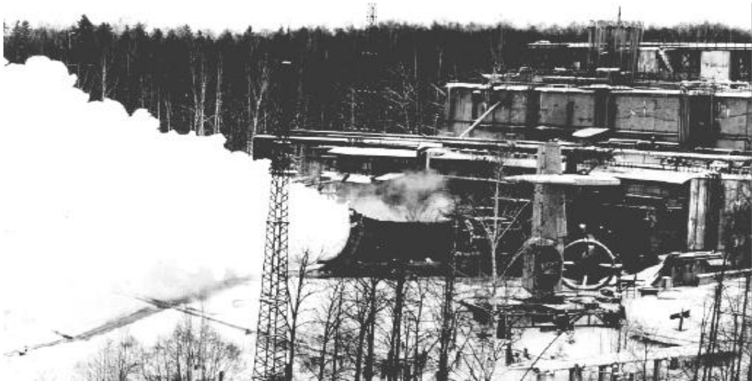
Рис. 2.21. Испытание ЖРД РД0120 на стенде с устройством глушения шума
